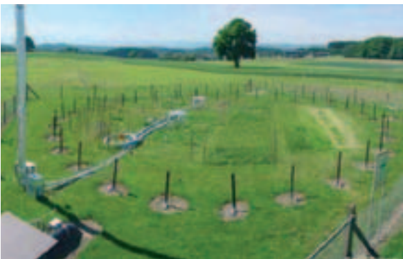
Freilandexperiment zur Untersuchung erhöhter CO 2 -Konzentration in der Luft (Free air carbon dioxide enrichment, FACE) an der ETH Zürich. Mit diesem Experiment werden Auswirkungen des vor allem durch Verbrennung fossiler Energien verursachten anthropogenen Treibhauseffektes untersucht.
